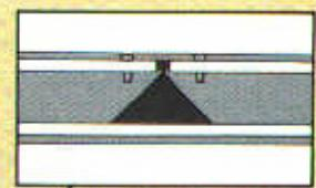
Je schneller der Zug fährt, desto größer muß die Distanz zwischen Kontaktunterbrecher-Schiene 1 und 2 sein, um das Anhalten des Zuges zu ermöglichen.
