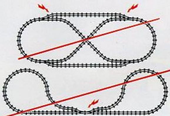
Die hier gezeigten Gleisanlagen sind kurzgeschlossen, weil in diesem Falle eine Plus-Phase auf eine Minus-Phase trifft. Der Stromkreis-Unterbrecher im Transformator tritt in diesem Falle automatisch in Aktion – der Zug kann nicht fahren.
