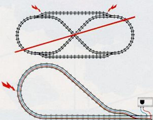
Einige Gleisanlagen können zu Kurzschlüssen führen. So zum Beispiel die hier gezeigte. Sollte es zu einem Kurzschluß kommen, schaltet sich der Transformator automatisch ab, und der Zug kann nicht mehr fahren. Um zu prüfen, ob bei Deiner Gleisanlage eine Kurzschlußgefahr besteht, brauchst Du nur die linke und rechte Schiene mit jeweils einer unterschiedlichen Farbe nachzuzeichnen. Sollten sich beide Farben auf der gleichen Seite treffen, gibt es einen Kurzschluß.
