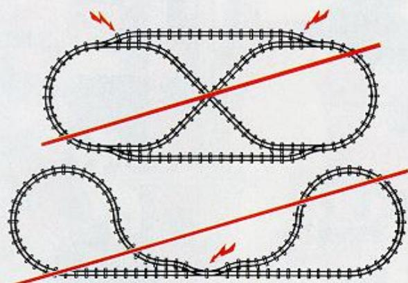
Die hier gezeigten Gleisanlagen sind kurzgeschlossen, weil in diesem Falle eine Plus-Phase auf eine Minus-Phase trifft. Der Stromkreis-Unterbrecher im Transformator tritt in diesem Falle automatisch in Aktion – der Zug kann nicht fahren.
